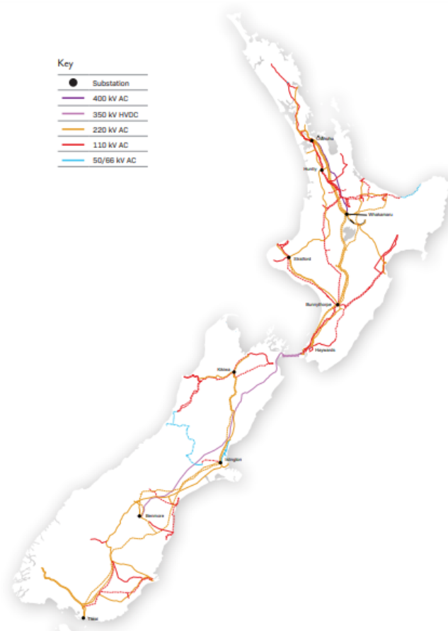
Figura 5.5. Sistema de transmisión de Nueva Zelanda 70 .
