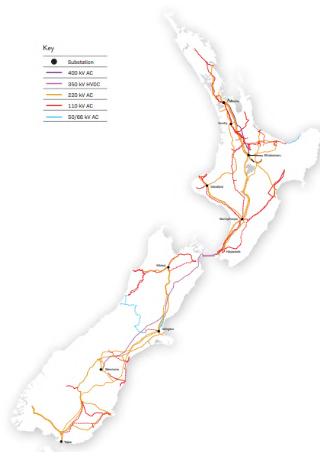
Figura 3.8. Sistema de transmisión de Nueva Zelanda 71 .
